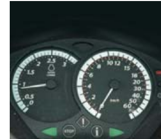
De snelheidsmeter (rechts) toont in oranje het bereik van de rijhendel. De wijzer geeft lage snelheden nauwkeuriger aan dan hoge.
