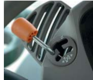
Naast belast schakelen tussen voor- en achteruit is er ook een parkeerstand. Die blokkeert de transmissie. Een handrem is er niet.
