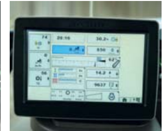
Het CommandCenter op de rechterconsole is zowel als touchscreen te bedienen als ook met een scrollknop.
