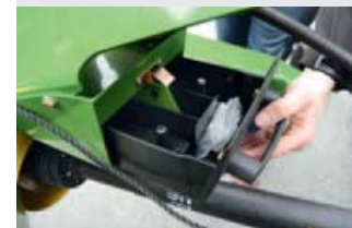
Reservemessen vind je terug in een bakje in de bok van de maaier.
