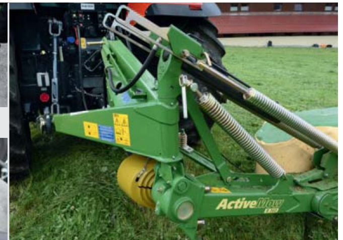
Het drukontlastingsstelsel van de Krone ActiveMow bestaat uit drie veren. Met de bovenste twee bepaal je de druk op de grond als de machine in transportstand staat. Met de onderste doe je hetzelfde in de werkstand.
