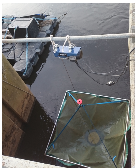
Figuur 2: Kruisnet met op de achtergrond de glasaaldetector.
