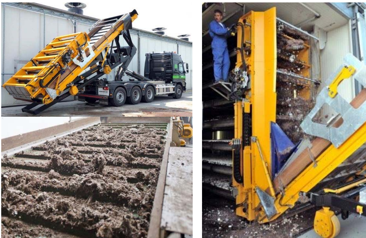
Figuur 13 Het ruimen van een cel bij een champignonkweker met een leeghaal-machine (Bron: Hofmans – www.hofmanshorst.nl ).
