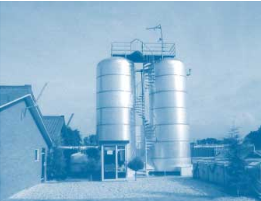
Figuur 2 Nitrificatie- en denitrificatietank van biologische mestbehandelingsinstallatie Biovink (Evink, Oosterwolde (Gld))
