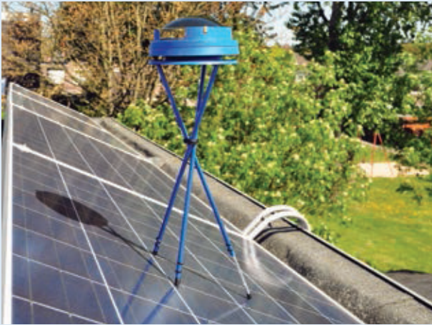
Afbeelding 7 Voorbeeld van een situatie waarin de eigenaar zich afvroeg of de hoge populieren van de gemeente (op de achtergrond) schaduw werpen op zijn PV-systeem. Uit analyse van de Zonnepadvinder-beelden blijkt dat niet zo te zijn. Maar de bomen in zijn eigen tuin (de bomen in het midden en de boom links die nog in knop staat), die kleiner zijn en veel dichterbij staan, blijken wél schaduw te geven als er blad aan zit, wat gelukkig op eenvoudige wijze met vakkundig snoeien weggenomen kan worden.
