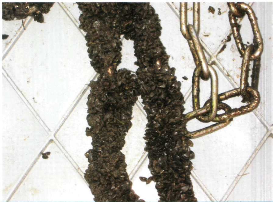
Kettingen van het filter zijn dichtbegroeid met mosselen (foto: TNO-MEP).
