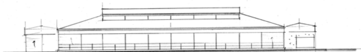
Pagodadak – lange gevel
