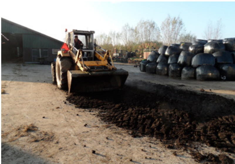
Op het erf kan de bagger verder gedroogd worden. Kluiten fijn maken door er met de trekker overheen te rijden
