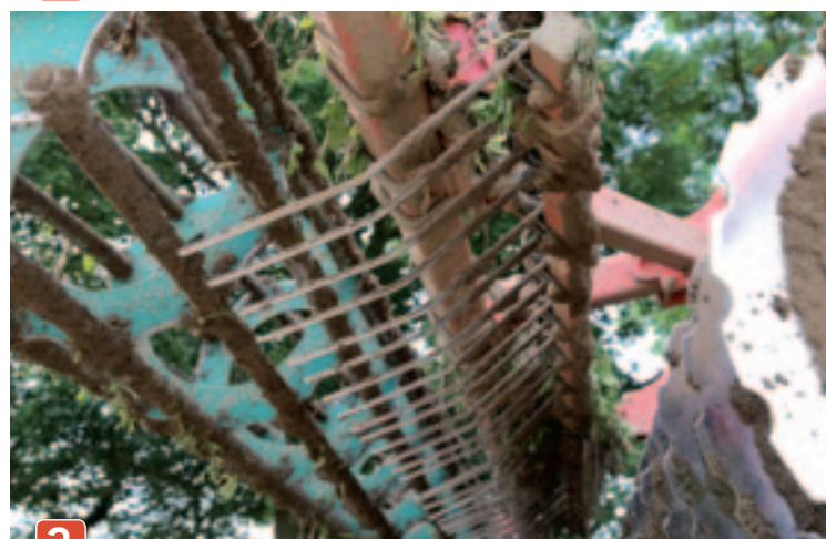
[1] De schijven hebben een diameter van 52 of 57,3 cm en zijn aan een onderhoudsvrij lager gemonteerd. Elke schijf wordt gedempt door vier torsiestaven.
