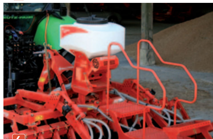
[4] Een dikke plus voor de zijplaten met parallellogramconstructie. Die werken uitstekend, zijn instelbaar en opklapbaar.
