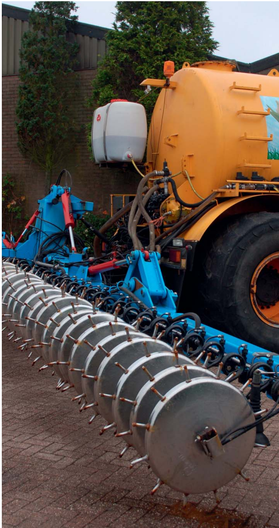
Met een spaakwielbemester kan de mest vlak bij de plant worden gebracht
