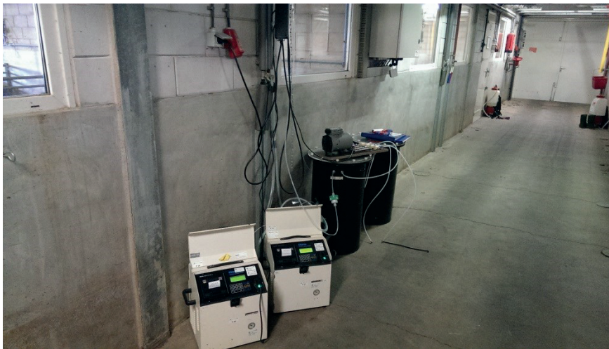
Pompen voor aanzuigen lucht voor PM10-meting en vaten voor geurmonster
