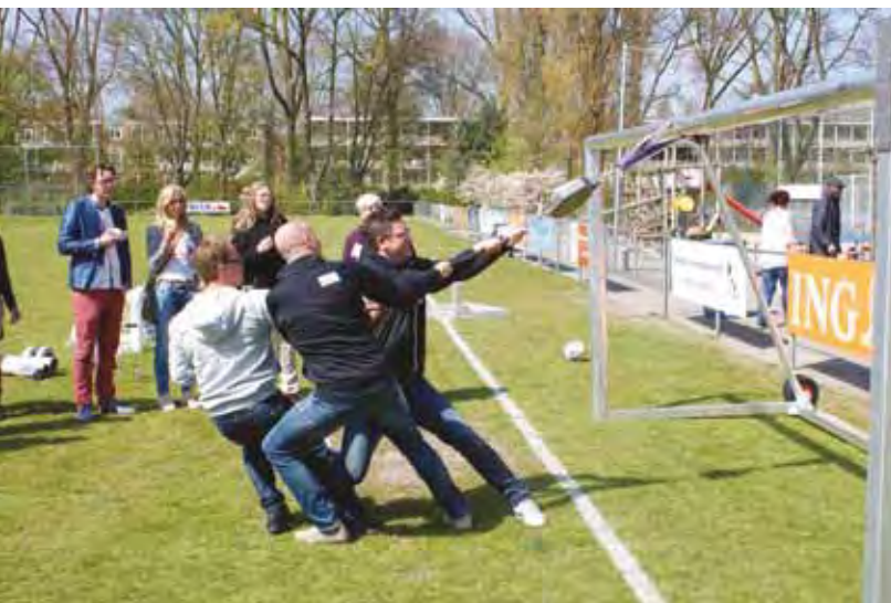
Volgens Duitse Tüv-normen moet een verplaatsbaar doel een trekkracht van 1100 Newton (circa 110 kilo) weerstaan zonder te kantelen.
