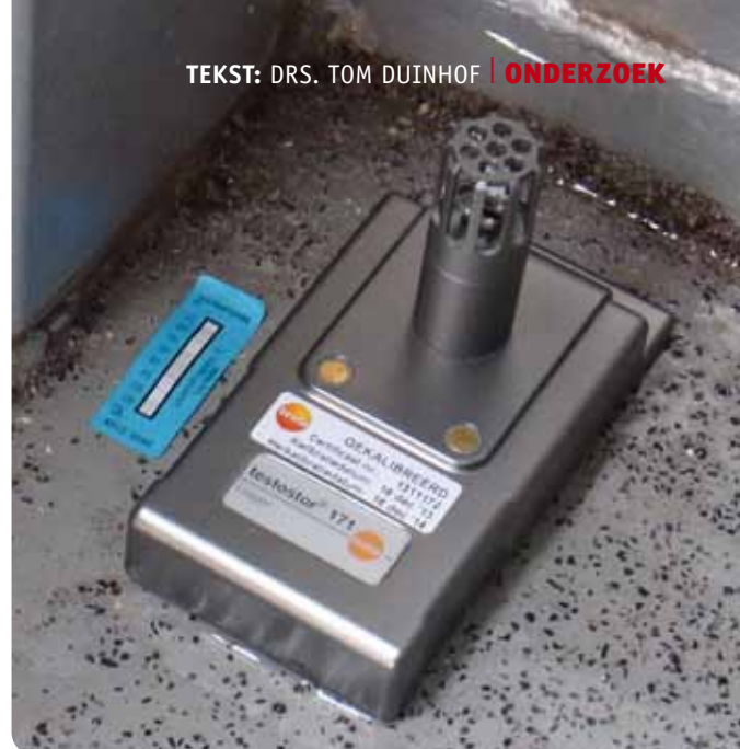
De blauwe strip geeft de bereikte temperatuur van de vloer aan. Met de logger daarnaast zijn de temperatuur en de relatieve luchtvochtigheid bepaald.
