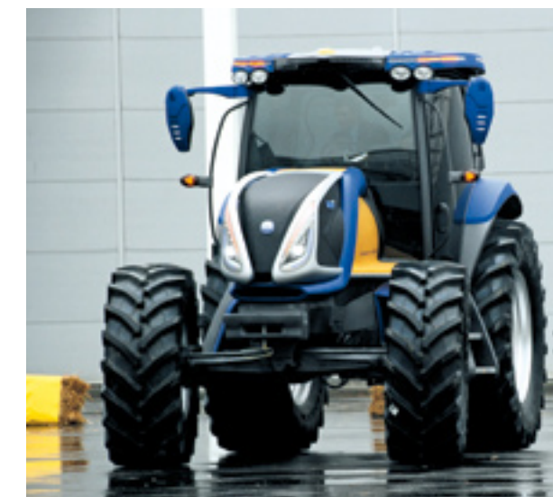
De New Holland NH2 heeft een brandstofcel. In de tank gaat waterstof.
