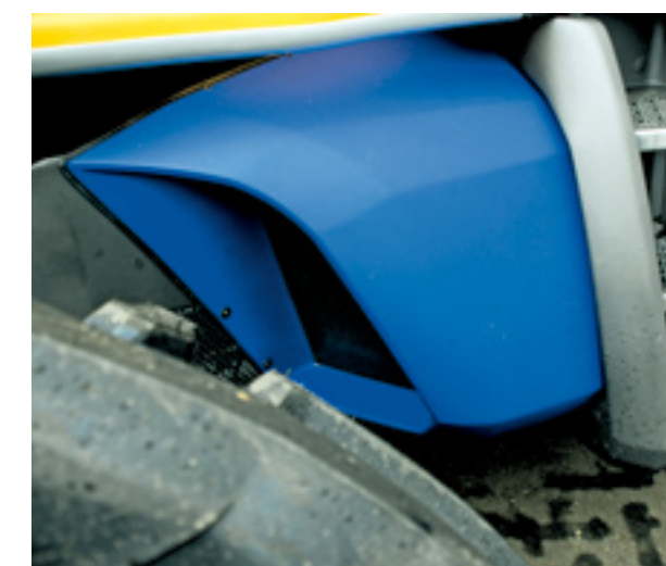
Om de elektromotoren te koelen, zijn er twee extra koelers gemonteerd.
