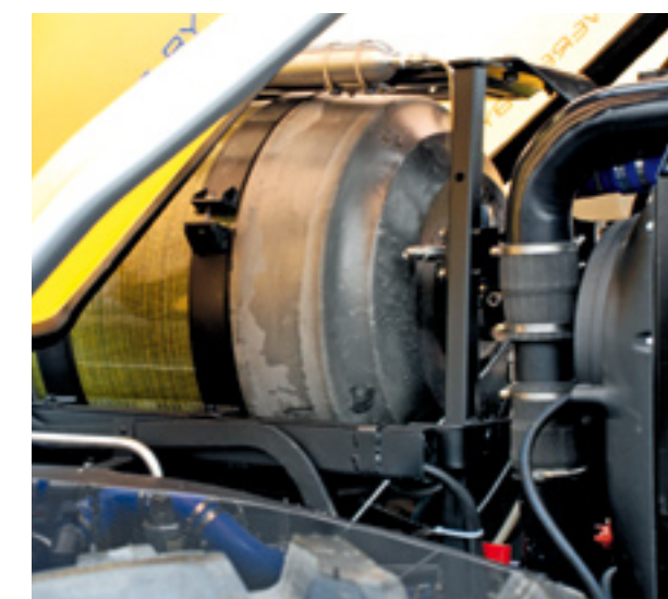
Onder de motorkap bevindt zich een 100 liter-tank waar de trekker zijn waterstof opslaat.
