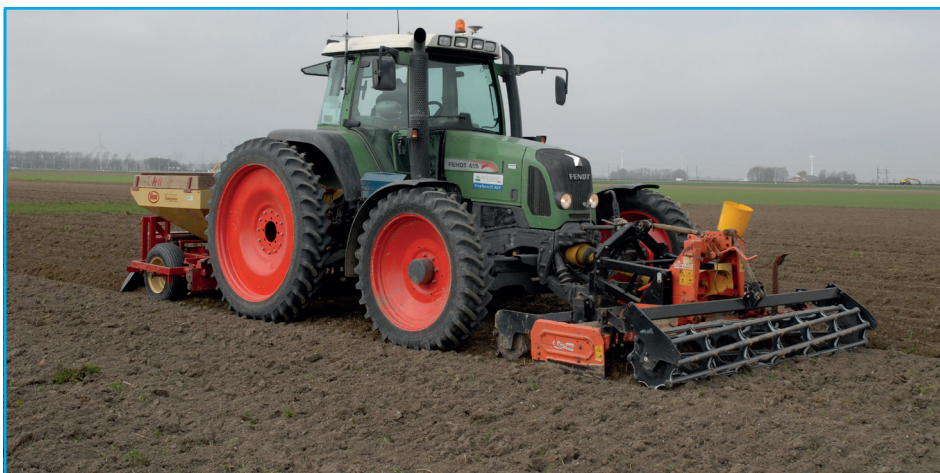
Foto 2 | Pootcombinatie met Masschio rotorkoeg en Vicon koningsplanter.
