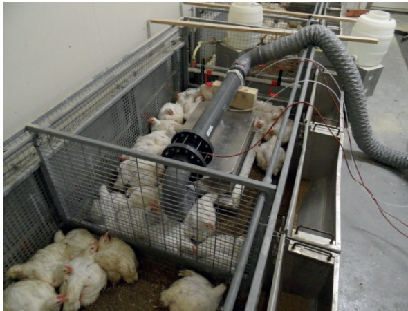
Figuur 2 Ammoniakemissie meting via de dynamische box meetmethode.
