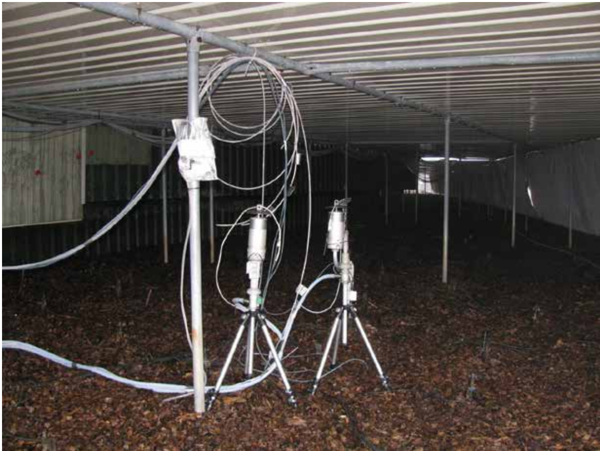
Figuur 2.8. Op deze foto zijn de monsternamekoppen (op statieven) te zien voor de fijn stofmetingen en de monsterleidingen voor de overige luchtmetingen. Aan de rechterzijde zijn (vaag) de zeilen te zien die de opening tussen dak en biobed afsluiten.
