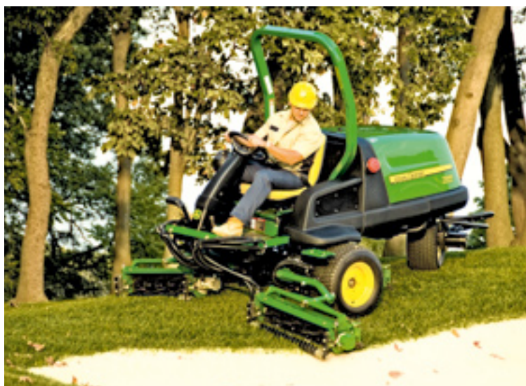
Met een sideshift zijn de kooien van de driedelige 7200 kooimaaiër 38 cm naar links en rechts te bewegen.
