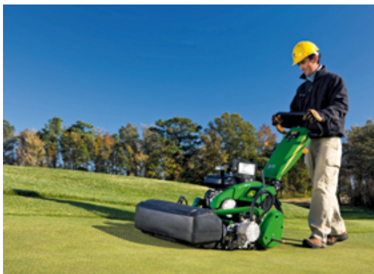
De floating maaiunit van de hybride 220 E-Cut handgreenmaaiër is elektrisch aangedreven.
