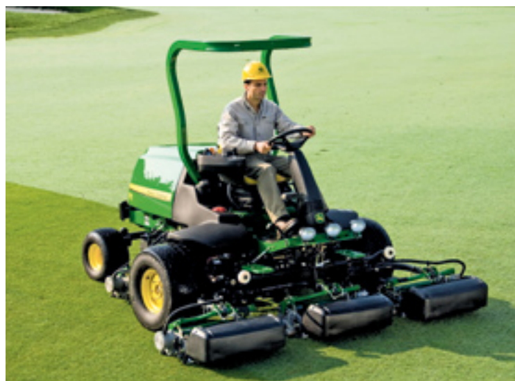
Naast hybride aandrijving hebben de E-Cut kooimaaiers ook nieuwe kooien. Speciaal aan de Quick Adjust kooien is de snelverstelling.
