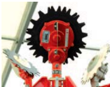
De dubbele messenkop voor de bosmaaier heeft het voordeel dat hij geen stenen, puin of andere harde onregelmatigheden wegslaat. Daardoor is deze vorm van maaien geschikt voor de woonomgeving of dicht in de buurt van auto's of winkelruiten. De afgebeelde versie is van Tiger en heeft als roepnaam RaceCut. De leverancier Pabst in Endingen is op internet te vinden onder tiger-pabst.de . Pellenc levert een soortgelijke maaikop onder de naam CityCut ( zie de impressie in dit nummer ) en bij Echo heet dit roterende knipmechanisme de Kreiselschere.
