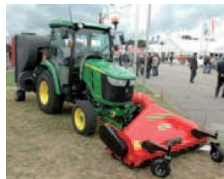
De John Deere 3045R met 33 kW (45 pk) zit in deze combinatie van Agritec tussen een klepelmaaier en een opvangbak, beide van Matev. De werktuigen zijn aangepast voor deze toepassing. Ze zijn normaal gesproken verbonden met een slang; die ontbreekt op deze foto. Volgens Agritec zorgen de luchtstroom vanuit de klepelmaaier en de zuigende werking van de ventilator op de opvangbak voor een probleemloos transport van het gras door de slang, ook als dat nat is. Klepelmaaien met afzuiging en opvang zijn al bekend van grootschalige aanpak, zoals bij wegbermen, maar in het kleinschalige van de tuin- en parktechniek is het vrij uniek. Agritec zetelt in Altlußheim, ten zuiden van Mannheim.
