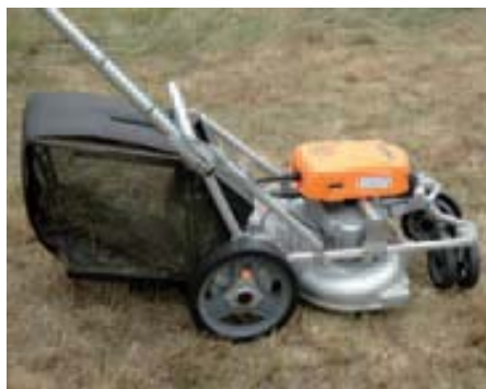
Een verrassende aanpak van Pellenc: de accu voor handgereedschappen die normaal op de rug wordt gedragen is nu gemonteerd op een loopmaaier. De maaier van lichtmetaal is een eigen ontwikkeling van Pellenc. Hoveniers die tuinen van particulieren onderhouden kunnen op deze manier met één accu bijna al het werk doen. De cirkelmaaier is er in een eenvoudige uitvoering van 1.100 euro en een chique van 1.600 euro. De prijs van de accu (1.040 euro) zit daar niet bij in, want die accu heeft u in de visie van Pellenc 'toch al'. Op de stand van de Franse fabrikant was de '1100-accu' ook op een onkruidborstel van Tielbuenger gemonteerd. Ook dat lijkt een logische aanpak.
