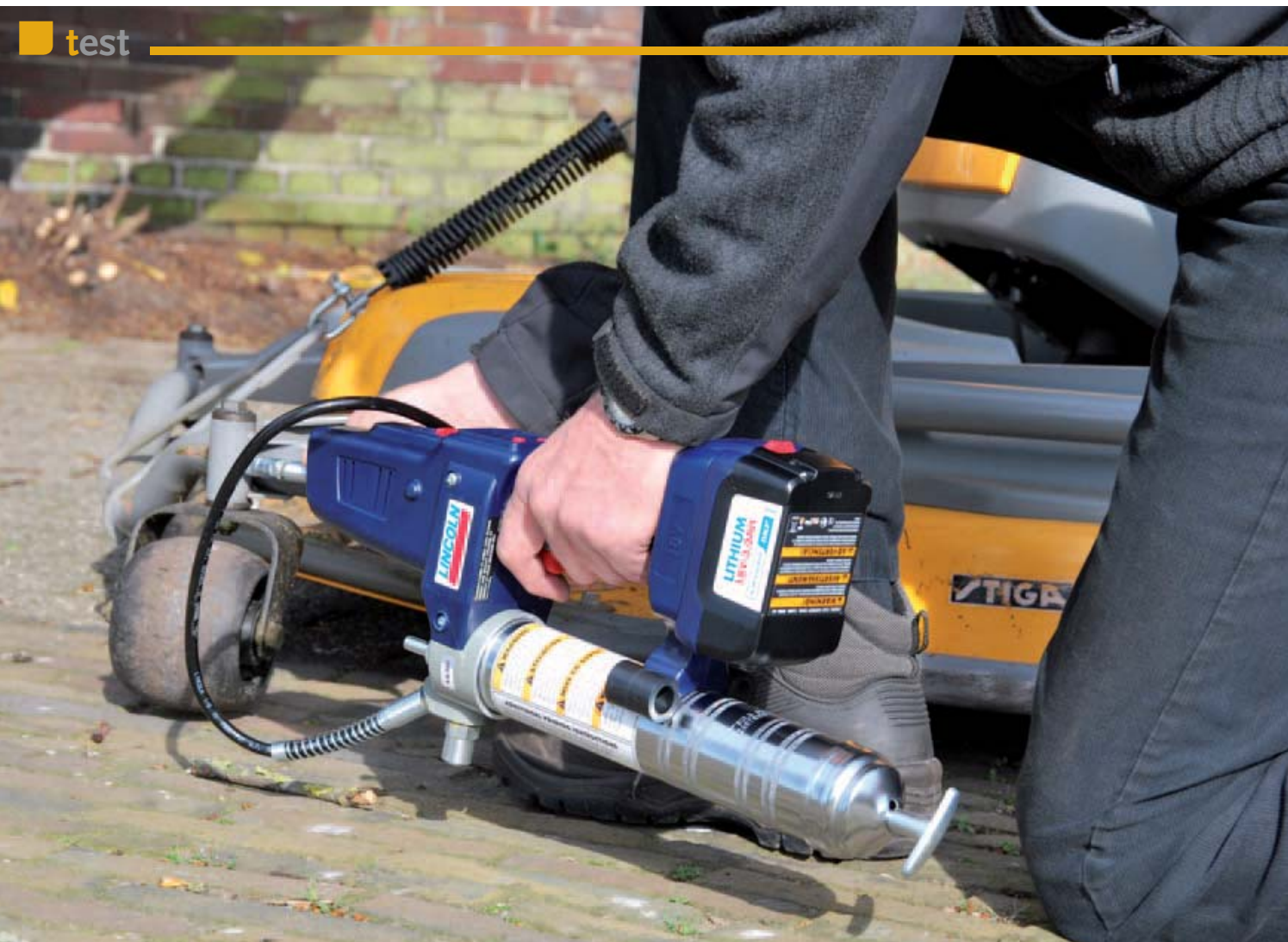
■ Het display van een accuvetspuit toont naast het aantal doseringen ook de hoeveelheid van die er nog is en de ladingstoestand.
