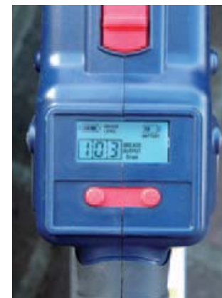
■ Het display van een accuvetspuit toont naast het aantal doseringen ook de hoeveelheid van die er nog is en de ladingstoestand.
