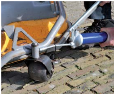
De schaarvertspuit wordt nog steeds het meest gebruikt en is onovertroffen waar het gaat om goed bereikbare nippels.
