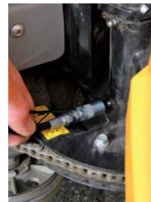
■ De slang heeft ten opzichte van het buisje als voordeel dat je om een hoekje kunt werken. Dat lukt goed met de accu- of pistoolversie.
