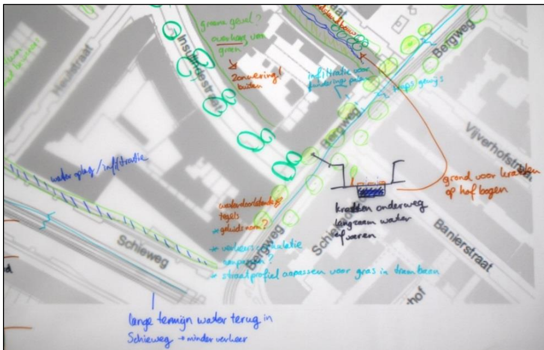
Figuur 16: Detail reconstructie blauwe adaptatiemaatregelen Bergweg met o.a. trapsgewijze infiltratiebedden (bron CPC schetsworkshop, 2013)
