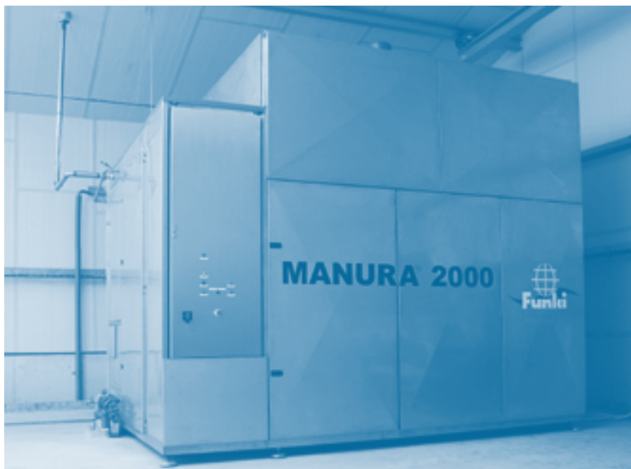
Figuur 2 Manura® 2000 unit voor behandeling van dunne fractie van varkensdrijfmest
