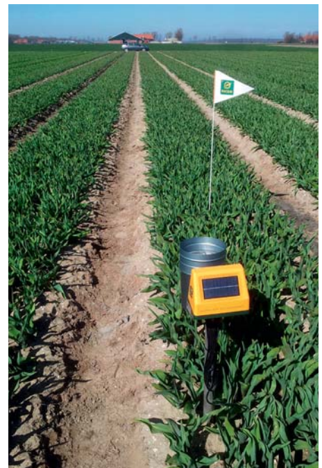
Bij twee deelnemers stond meetapparatuur opgesteld om te bepalen wanneer beregenen noodzakelijk is
