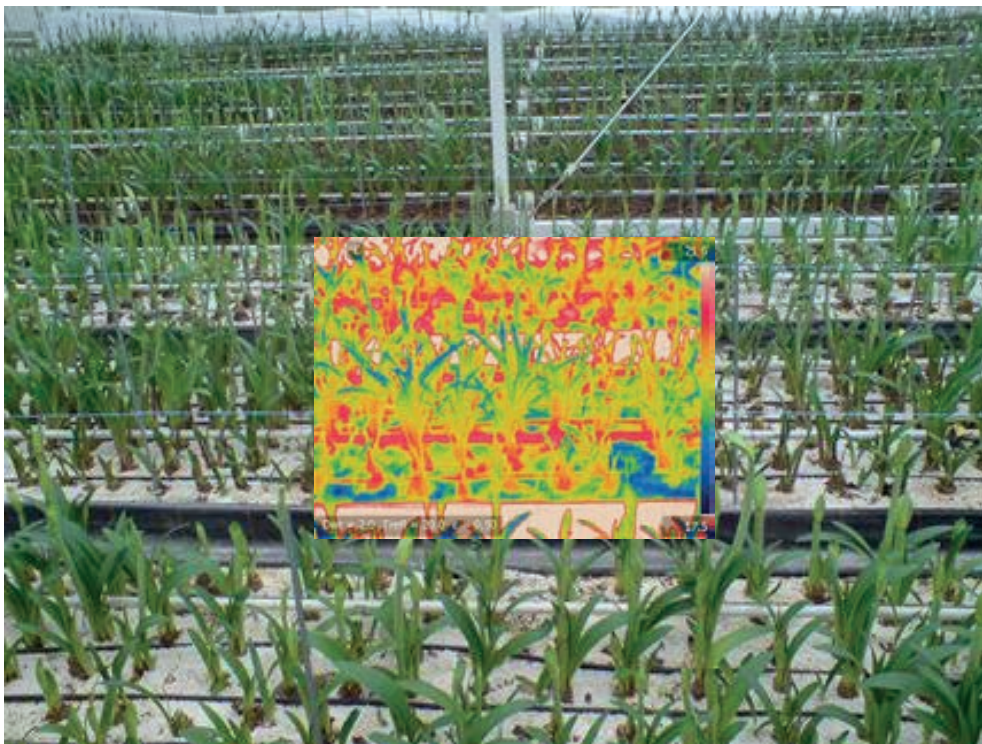
Figuur 7 Gewastemperatuur gemeten met een IR-camera op 27 november 2013.
