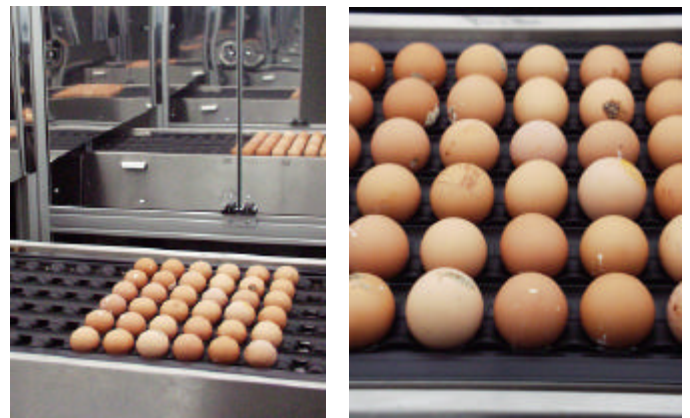
Figuur 2: De eieren worden getransporteerd op een bewegende rollenbaan met diabloachtige rollen waarin de eieren draaien om hun lengte as. Er bevinden zich maximaal 6 eieren tussen 2 rollen.
