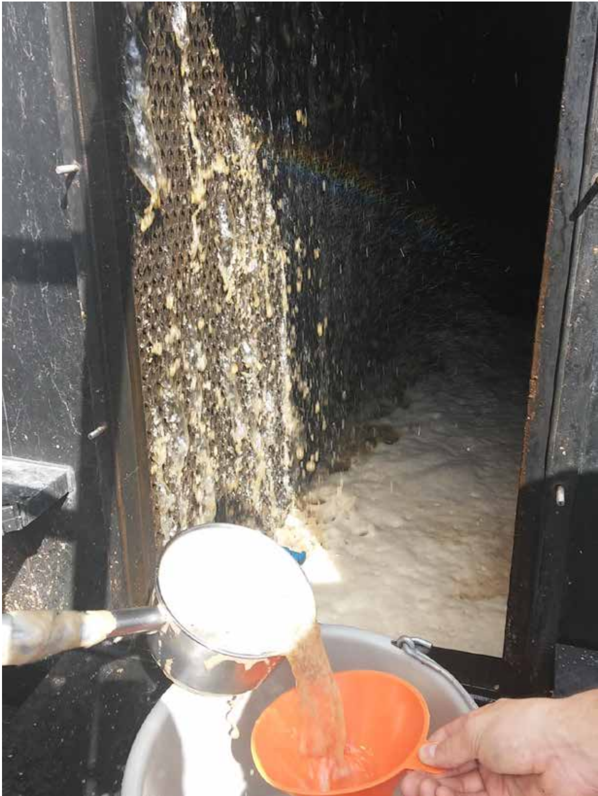
Figuur 3 Monsternamen van bassin door waswater uit bassin te scheppen met steelpannetje.
