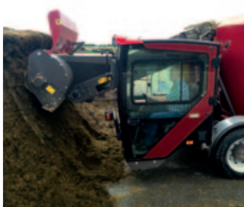
De voerfrees laat een strakke kuil achter. Vanuit de cabine heeft de bestuurder goed zicht op het werk.
