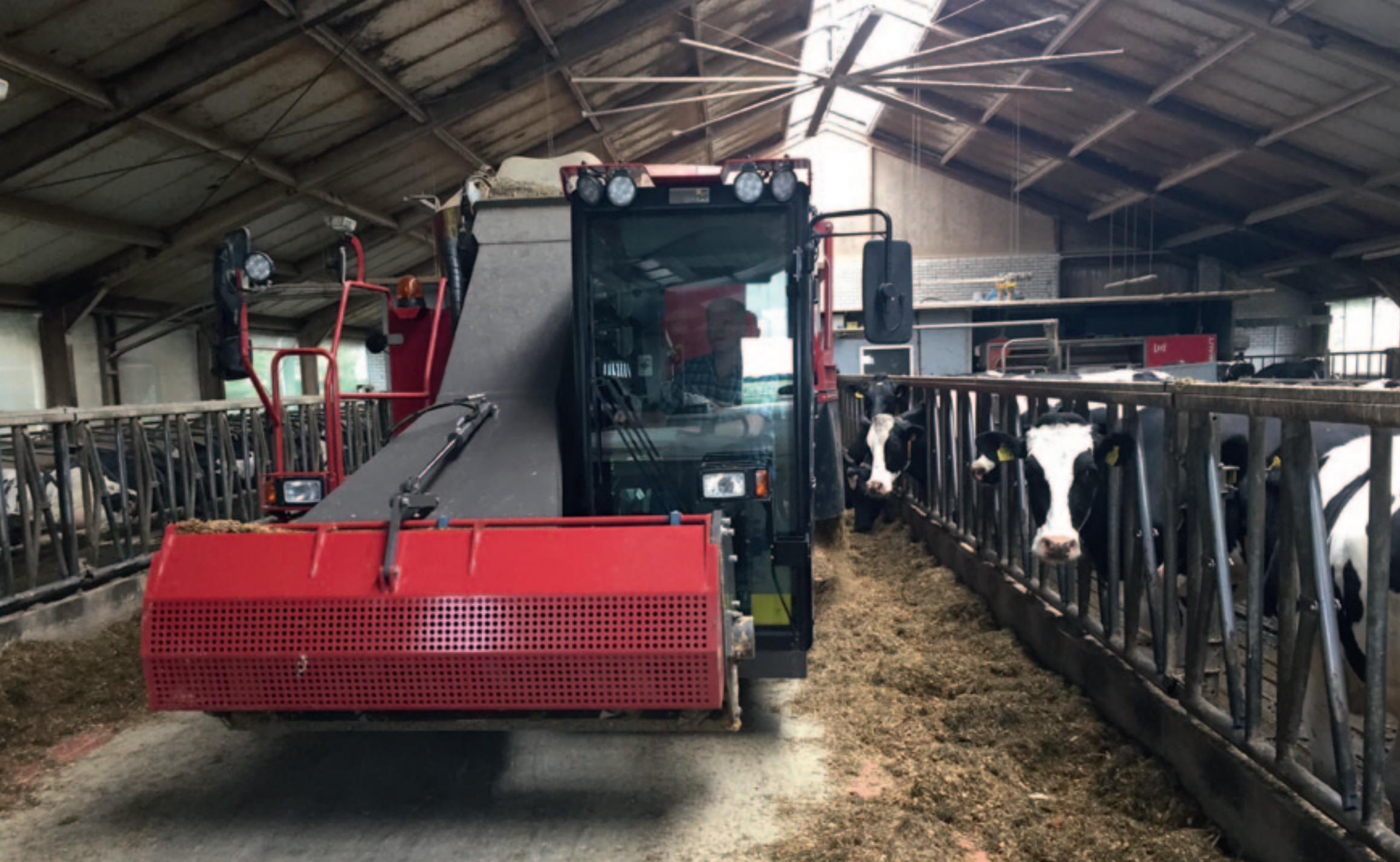
De voerfrees heeft 60 messen die het voer uit de kuil slaan in plaats van snijden. Dit zorgt voor het behoud van de structuur van het voer.
