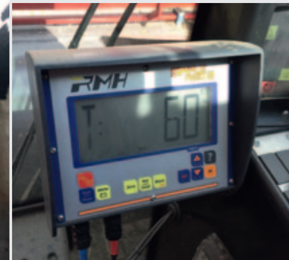
Het bedieningspaneel geeft het gewicht van de geladen hoeveelheid voer weer en stelt je in staat om de juiste hoeveelheid te laden.
