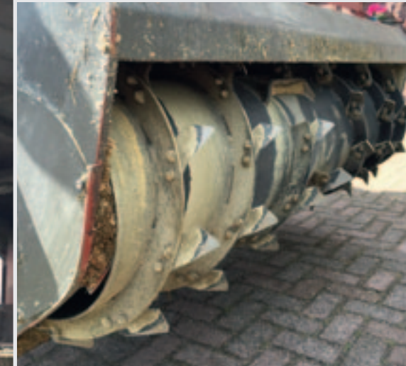
De voerfrees heeft 60 messen die het voer uit de kuil slaan in plaats van snijden. Dit zorgt voor het behoud van de structuur van het voer.
