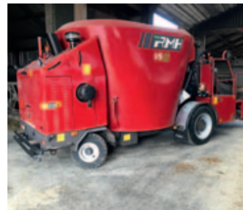
Aan de achterkant van de voermengwagen zit een veiligheidssysteem. Raken de twee horizontale buizen iets, dan wil hij niet meer achteruit.
