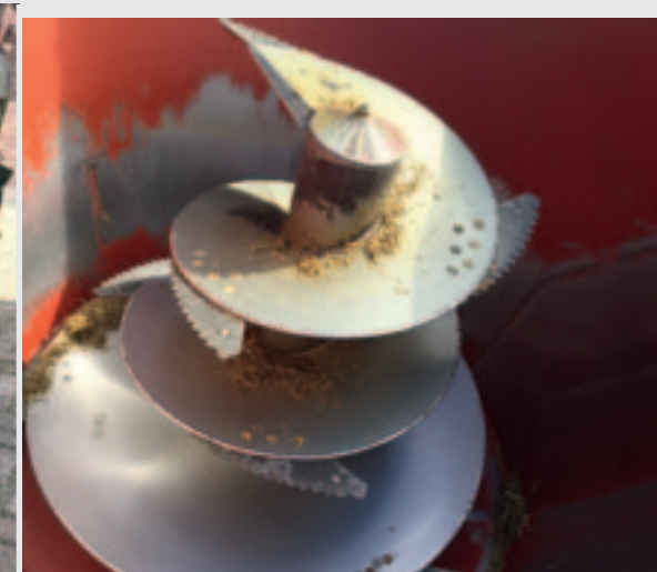
De verticaal geplaatste mengvijzel is voorzien van parabolisch gevormde messen. De vijzel kan op twee snelheden draaien.
