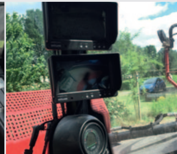
Veel gebruikers kiezen voor een extra camera-scherm. Zo houden ze altijd zicht op de mengbak en op de achterzijde van de machine.
