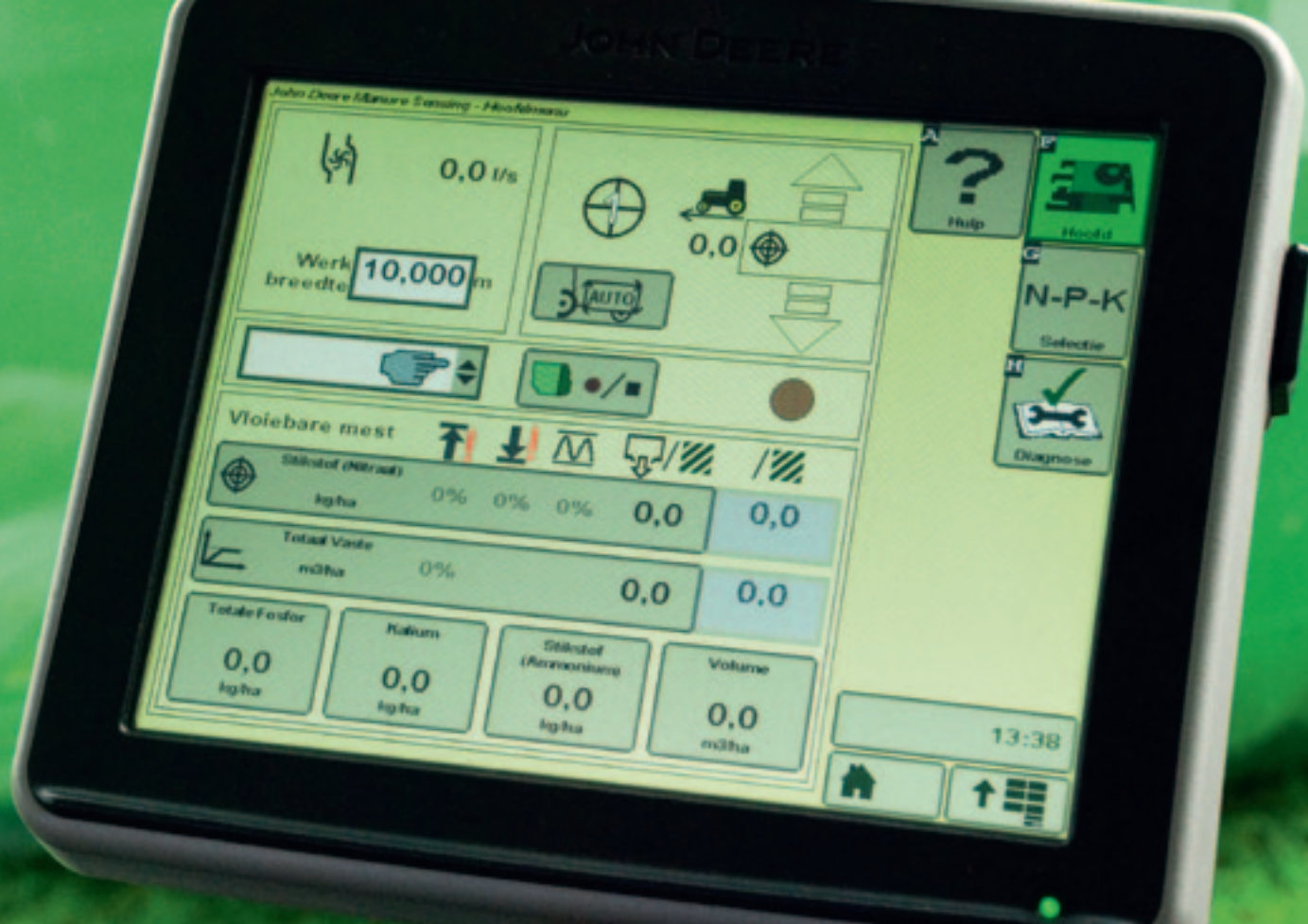
Dit scherm geeft onder meer real-time de gehalten aan van de mest, bepaald met NIRS. Ook de ingestelde toepassingsnormen voor mineralen zijn te zien. De foto werd genomen op Agro Techniek Holland waar John Deere in samenwerking met partners Kotte, Fliegl en Vervaet het concept 'Manure Sensing' liet zien. NIRS-mestanalyse wordt hier dus gebruikt om zeer precies mineralen aan te wenden. De volgende stap met NIRS-mestanalyse, zou je kunnen stellen.
