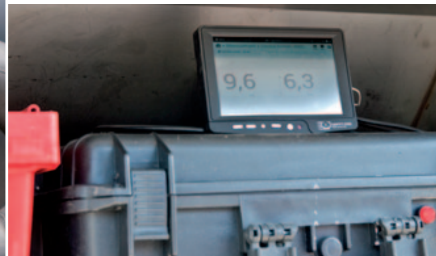
Door de real time analyse van de mest, is op een monitor per seconde te zien hoe de stikstof- en fosfaatgehalten per seconde veranderen.
