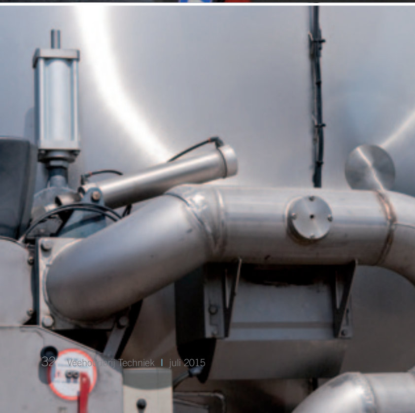
< D-Tec rust zeven mesttrailers uit met een combinatie van reguliere monsternameapparatuur en NIRS. De laatste zit achter het ronde plaatje.
