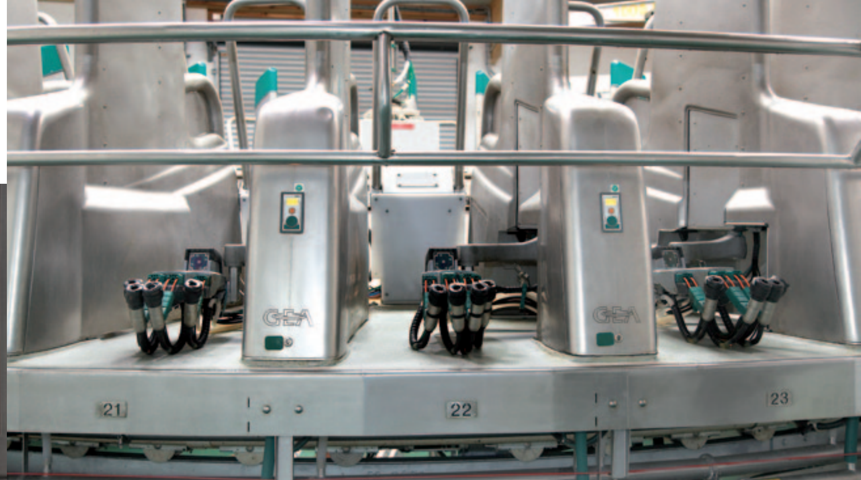
De Stall-units staan op platform van de GEA-Performer. De Stall-unit is zo compact dat geen groter platform nodig is dan normaal. Bij de installatie van de Dairy ProQ begin je het onderscheid van de Performer-buitenmelker dus pas te zien bij het storten van het beton. Daarin worden bevestigingspunten voor de Stall-units gemonteerd.
