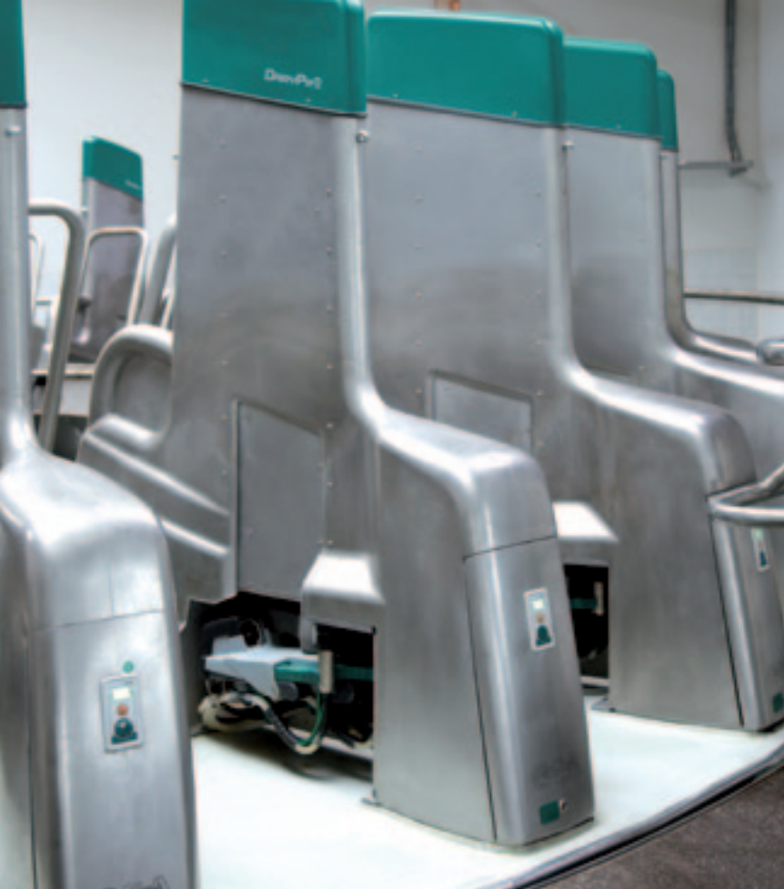
Deze zuilen noemt GEA de Stall-units. Ze worden als geheel geleverd en bevatten de aansluitarm. Voor- en nabehandelen gebeurt in de tepelbeker.
