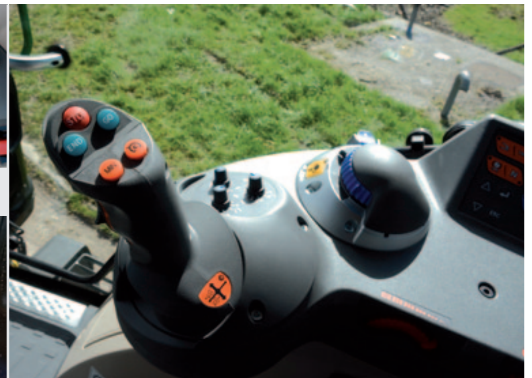
Het rechterzijconsole van de Fendt 310 Vario Power. Met de joystick bedien je de transmissie. De knoppen bovenop zijn onder meer voor het programmeren van de cruise control
