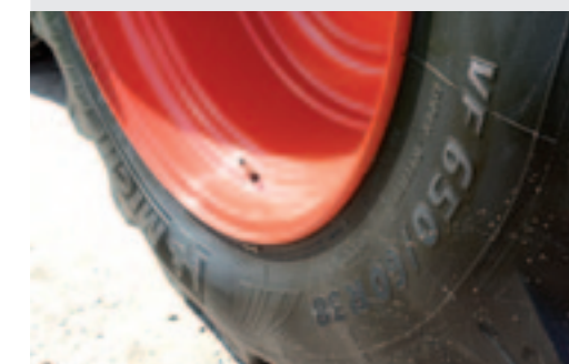
Onder de trekker passen grotere banden dan op zijn voorganger. Maximaal 650/60R38 achter.
