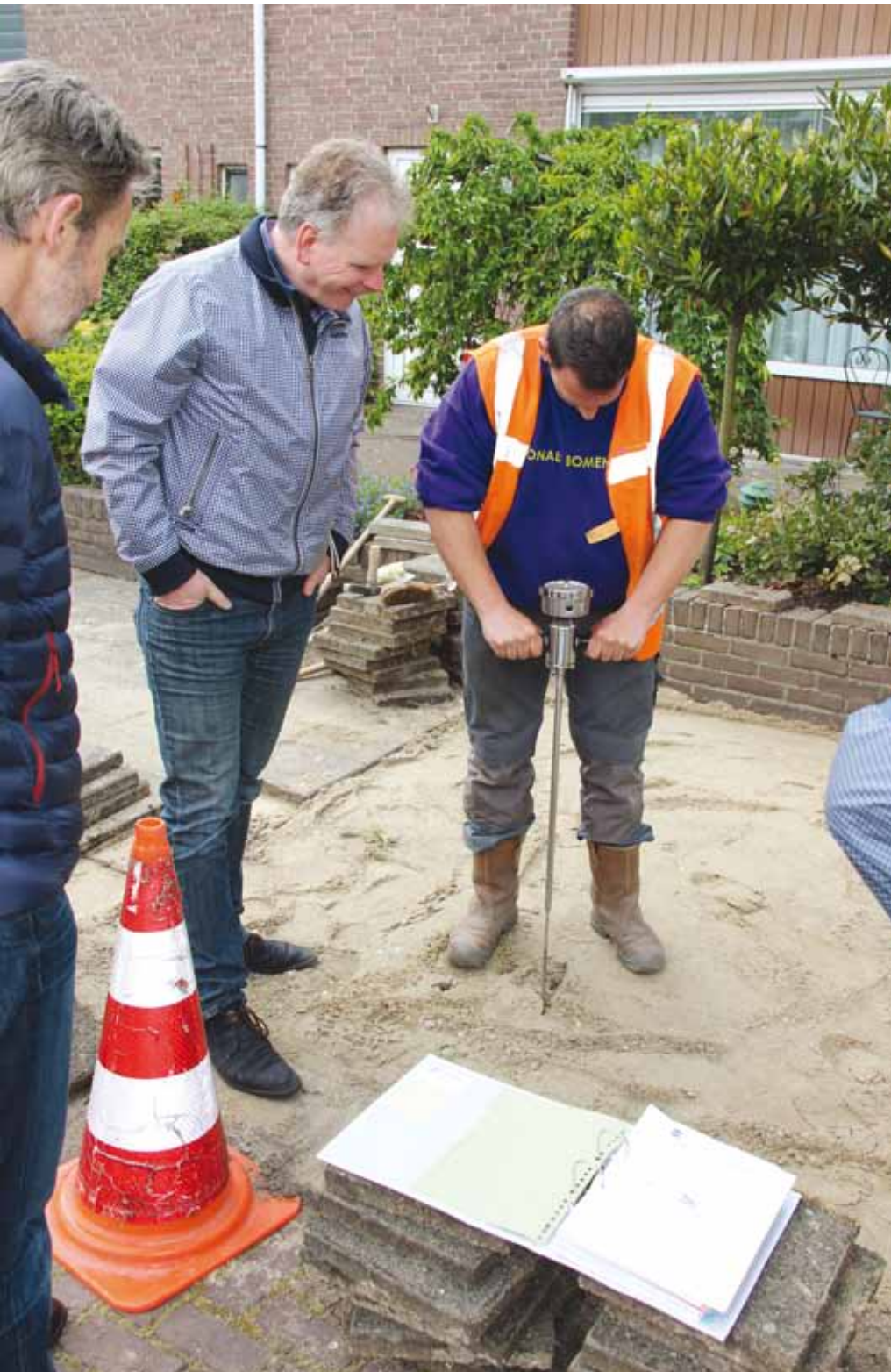
Wevers wil voor de zekerheid toch even ter plaatse de indringingsweerstand controleren.
