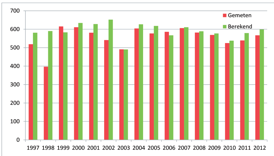
Afbeelding 5: Gemeten en berekende werkelijke verdamping in het Loobos (mm/j) voor de periode 1997-2012 (Querner en Moors, 2013) 9 .
