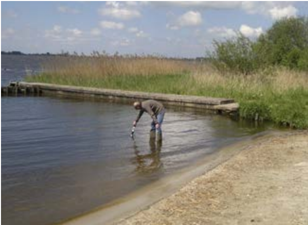
Meting van blauwalgen met de BBE Moldaenke Algae Torch, mei 2011 (foto Laboratorium WF).
