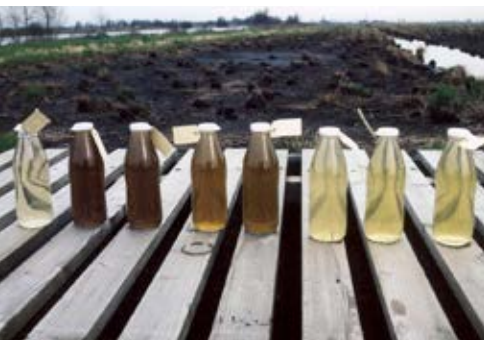
Door humusstoffen (dissolved organic carbon) gekleurd water in een gradiënt door het filter van voor (rechts) naar achter (links); de meest linker fles is water uit het achterliggende petgat, april 1997.
