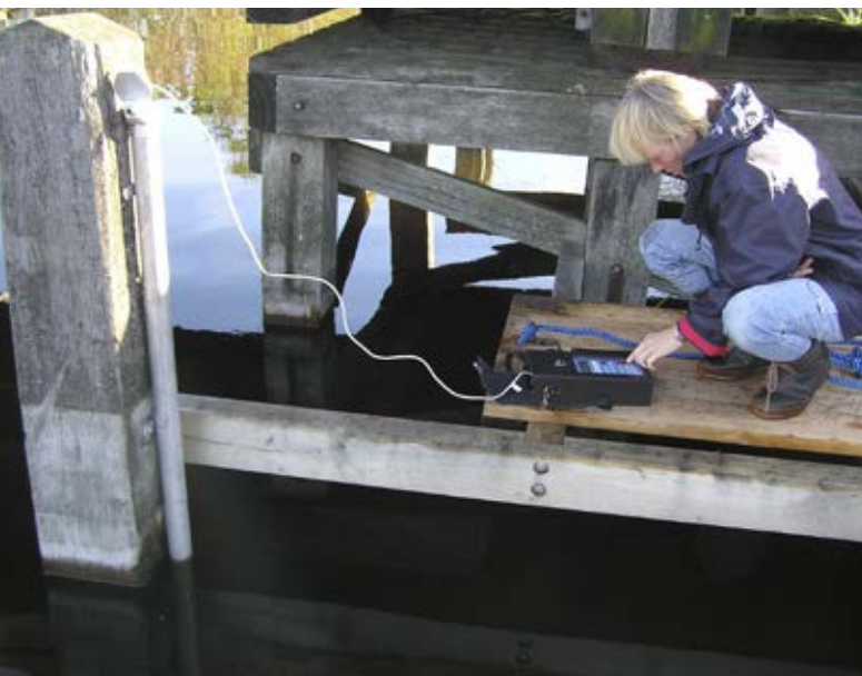
Uitlezen van datalogger van permanent opgestelde meetsonde, september 2004.
