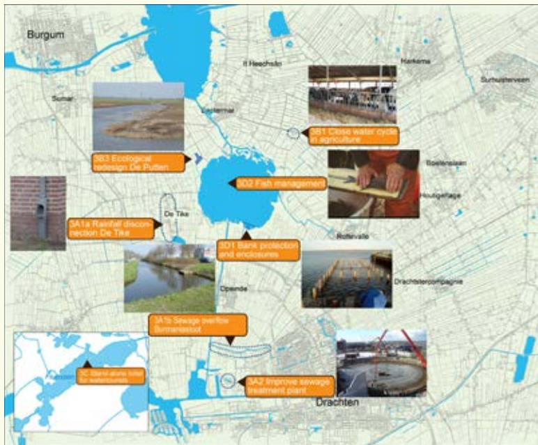
Figuur 7.4. Maatregelen in en om de Leijen, genomen in het kader van het NOLIMP-project (uit Claassen, 2004b).
