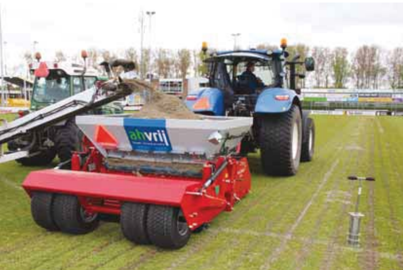
De Vibra-Sandmaster bestaat uit een schudfrees met sleuvenvulmachine.
