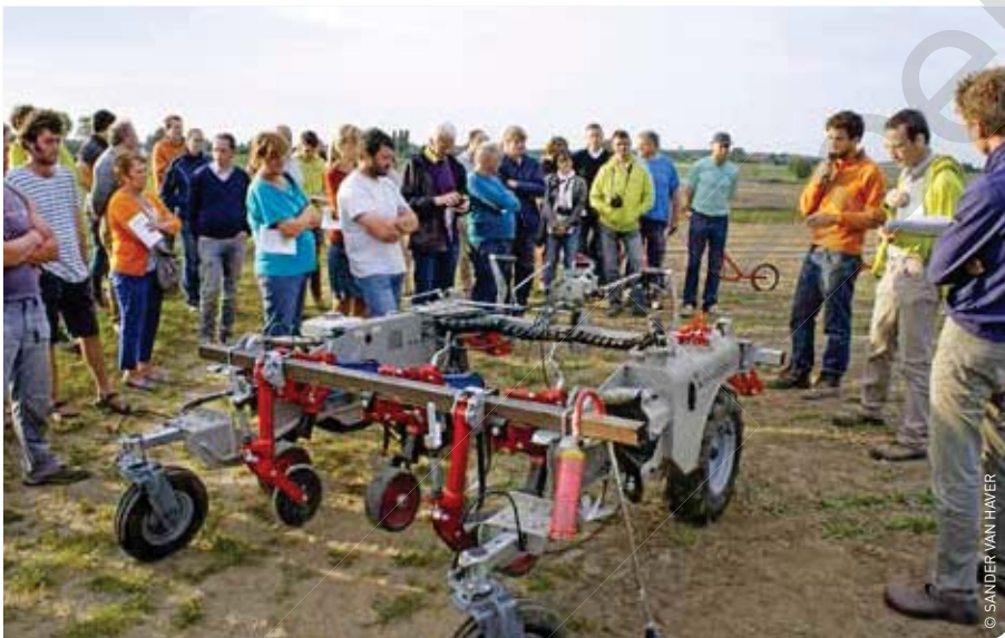
Met de CultiTrack-werktuigendrager kunnen ook fijne teelten onkruidvrij gehouden worden.
