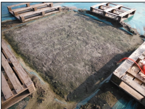
Foto C – Veldtoepassing van Bodem Resetten met testen van coating als mogelijk alternatief voor folie
