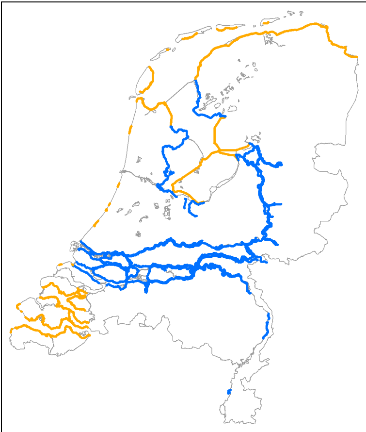
Figuur 3.1 Overzicht dijkringtrajecten die niet (oranje) en mogelijk wel (blauw) gevoelig zijn voor opbarsten/piping en macrostabiliteit
