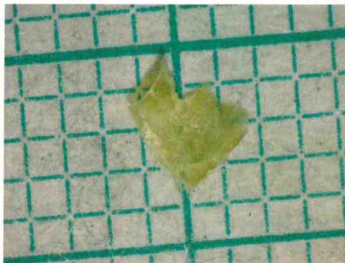
Bild 6: Dünner Kunststofffilm, der mit der Quest Diamant-Einfach-Reflexionseinheit im FTIR-Spektrometer gemessen wurde.
