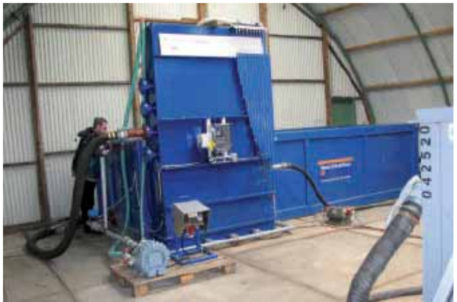
Een dubbellaags cellenfilter (actieve kool/zand) met druk- en kwaliteitsmeetstelsel.
