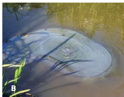
Foto's van wellen. A: Wel met opborrelend gas, B: Grote zandmeevoerende wel met een zone waar zand in suspensie is (doorsnede is 40 centimeter), C: Zandmeevoerende wel die boven het slootpeil uitkomt en een soort 'puinwaaier' vormt.
