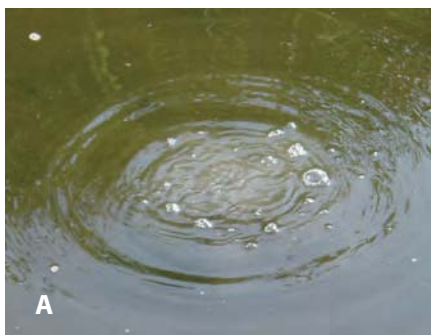
Foto's van wellen. A: Wel met opborrelend gas, B: Grote zandmeevoerende wel met een zone waar zand in suspensie is (doorsnede is 40 centimeter), C: Zandmeevoerende wel die boven het slootpeil uitkomt en een soort 'puinwaaier' vormt.
