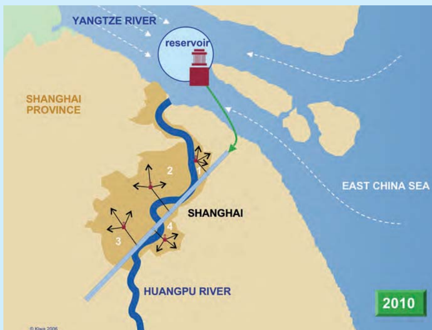
Afb. 2: Schematische weergave van de watervoorziening in Shanghai in 2010.
