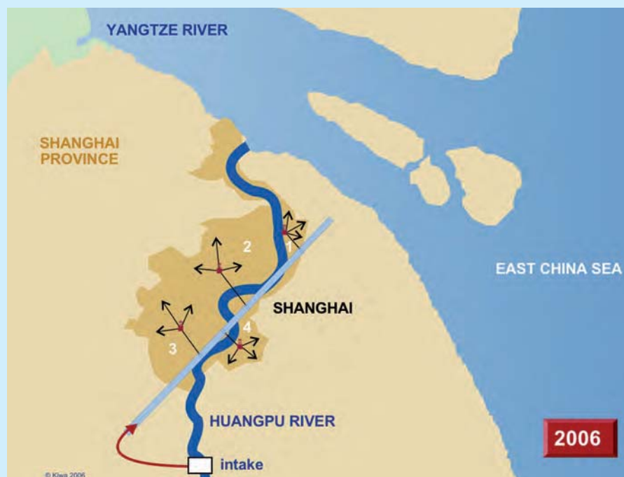
Afb. 1. Schematische weergave van de huidige watervoorziening in Shanghai: eenvoudig voorgezuiverd water gaat naar lokale zuiveringsstations.
