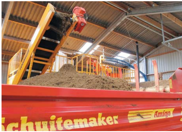
Het eerste waar vader en zoon Jonkman in investeerden, was de mestverwerkingsunit van Veenhuis. De gehygiëniseerde mest verkleint het risico op hittebestendige bacteriën, een mooie extra 'verzekeringspremie' voor de biobedding, aldus Jonkman.
