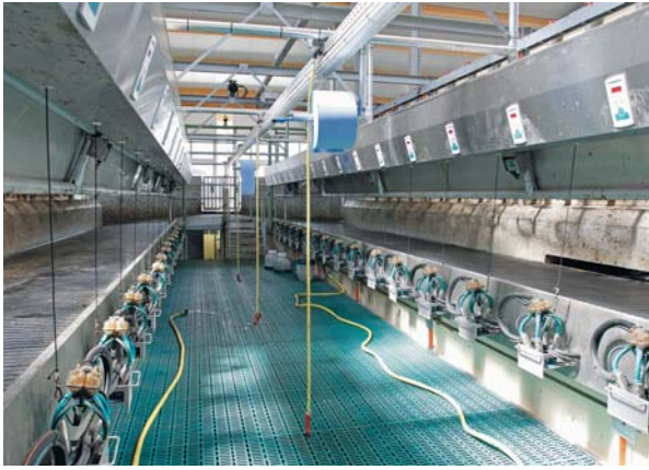
In de 2 x 20-stands zij-aan-zij melkstal van GEA kunnen per uur 150 à 160 koeien worden gemolken. De maatschap Jonkman wil melkers inhuren. Daarom is de put uitgerust met een beweegbare vloer.
