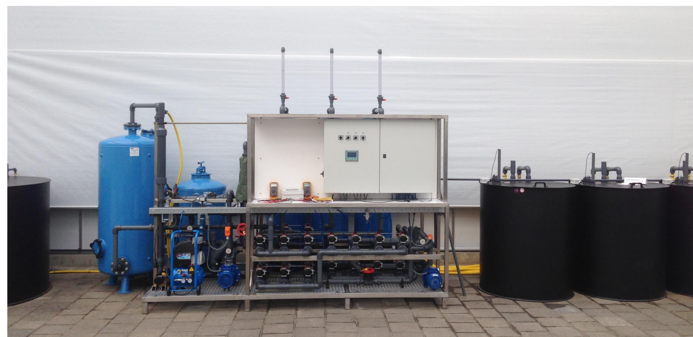
Figuur 2. Testopstelling van de apparatuur om nitraat uit drainwater te verwijderen.
