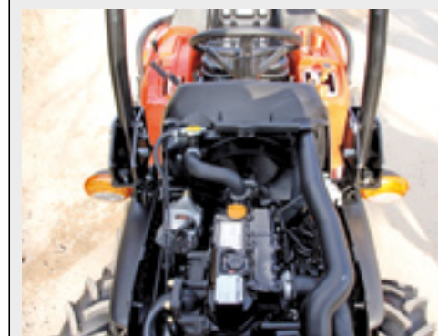
De motor ligt omgekeerd onder motorkap. De ventilator zit onder het stuur.
