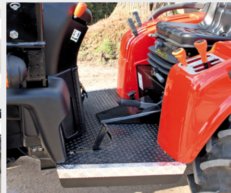
Door de vlakke vloer is er veel ruimte voor de benen. Onder de verstelbare stoel zit tussen de benen nog wel een handrem.
