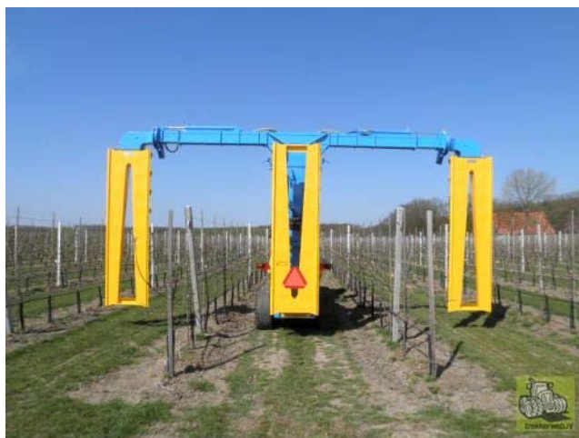
Afbeelding 2.2 Een drierijige spuit type KHW 3R. Bron: abemec.nl
