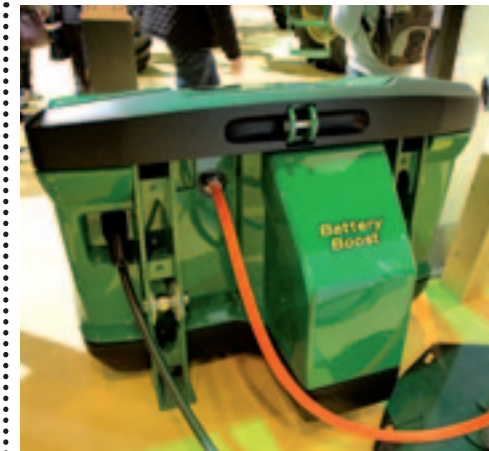
^ Frontgewicht voor extra spanning Battery Boost is de naam van dit frontgewicht van John Deere. Het is gevuld met accu's. Die bieden bij de 6RE maximaal 107 kW aan elektrisch vermogen voor het werktuig, maar kunnen ook de normale trekker helpen om tijdelijke arbeidspieken te overbruggen.
