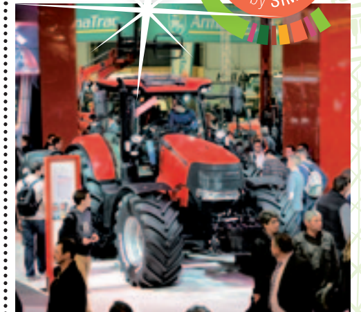
^ Case IH Puma New Holland komt met de T7, Case IH met de Puma. Het vermogen dat tussen 111 en 179 kW (150 en 240 pk) ligt, komt uit dezelfde 6,7 liter zescilinder FPT-motor. Isobus is ook opgevaardeerd. Zo kan de machine de trekker sneller of langzamer laten rijden.
