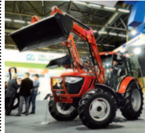
^ TYM T1054 Het Zuid-Koreaanse TYM voegt een 78 kW (105 pk) trekker toe aan het gamma. Dat vermogen komt uit een Doosan-viercilinder motor met AdBlue. De trekker heeft 36 versnellingen voor- en achteruit. De Bosch-hef tilt 3.110 kg. De trekker kost 54.000 euro.
