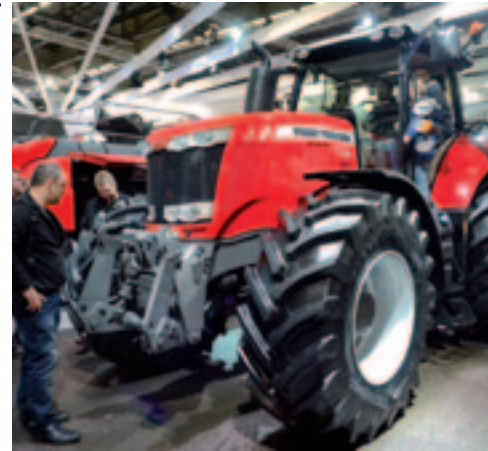
^ Massey Ferguson 7700 Massey Ferguson vervangt de 7600-serie. De zes kleinsten uit de 7700-serie halen hun vermogen uit een 6,6 liter motor. De grootsten uit een 7,4 liter zescilinder. Op de acht grootste modellen heb je keus uit een zestraps-powershift of een traploze bak.
