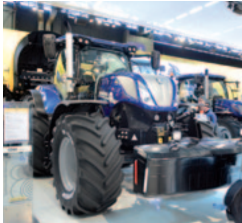
^ New Holland T7 De New Holland T7-serie, met het uiterlijk van de T8, omvat acht modellen met een vermogen van 130 tot 201 kW (175 tot 270 pk). De vier kleinsten hebben een 15 cm kortere wielbasis dan de grootsten. De trekker is leverbaar met cvt of powershifttransmissie.
