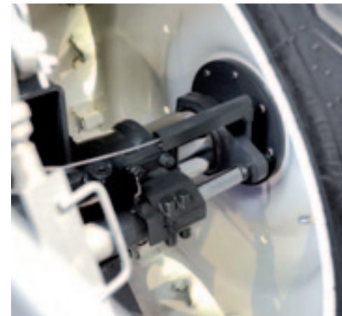
^ Uitschuifbare as De ontwikkelingsafdeling van Kubota is niet alleen bezig met nieuwe powershiftversnellingsbakken, maar ook met hydraulisch uitschuifbare assen voor trekkers onder 75 kW. Hiermee kun je de spoorbreedte variëren van 120 tot maximaal 144 cm.
