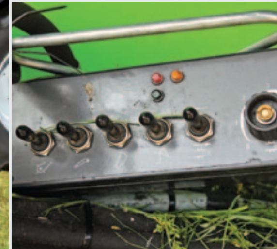
De bedieningskast waarmee je de bodemketting, de opraper, de kniksiddel, de snij-unit en de achterklep van de wagen bedient.
