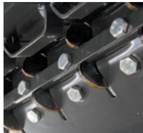
De strip achter de messen is gevoelig voor slijtage. Daardoor ontstaat speling op de messen en op den duur kunnen ze er zelfs uitvallen.
