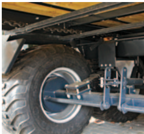
De wagen kan geleverd worden op 56 cm brede banden. Dan wringt het wel in de bochten. Een meelopend-gestuurde achteras biedt soelaas.
