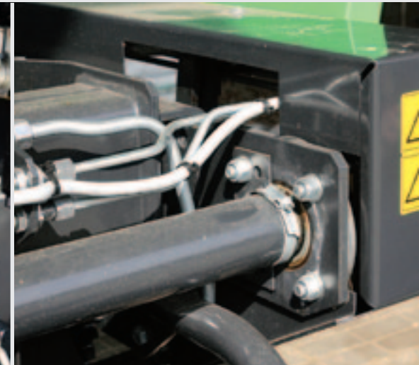
Het lager van de hoofdaandrijving is te licht uitgevoerd en daarom storingsgevoelig. Een geluk is dat het lager dan wel goed bereikbaar is.
