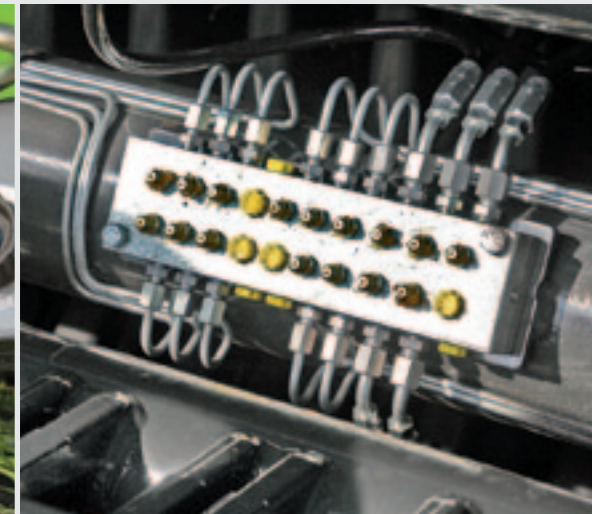
Om de 10 tot 12 hectare moet de invoer worden gesmeerd. De smeerpunten voor de balken zijn bij elkaar geplaatst.
