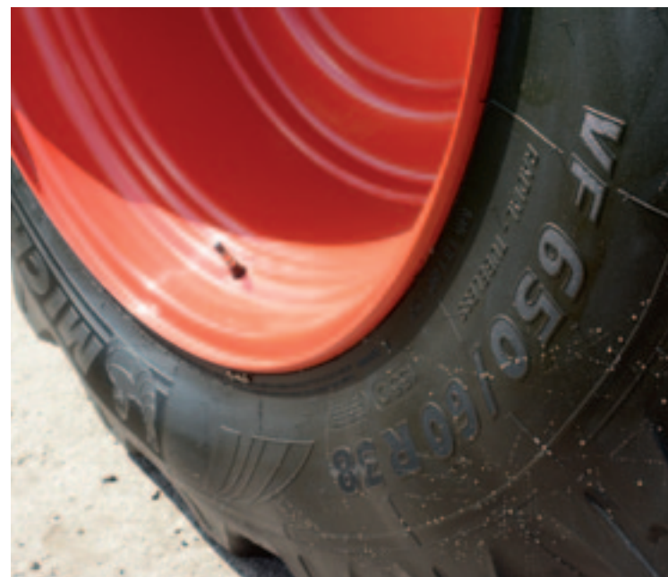
^ Brede banden Onder de trekker passen grotere banden dan op zijn voorganger. De maximale maat is 650/60R38 achter en 540/65R24 op de geveerde vooras.
