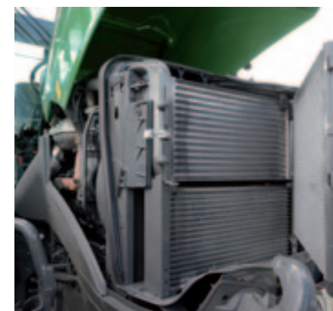
^ Koelpakket Om het koelpakket te reinigen klap je de voorste koeler weg en bij de achterste moet je een rubber afdekplaatje verwijderen.
