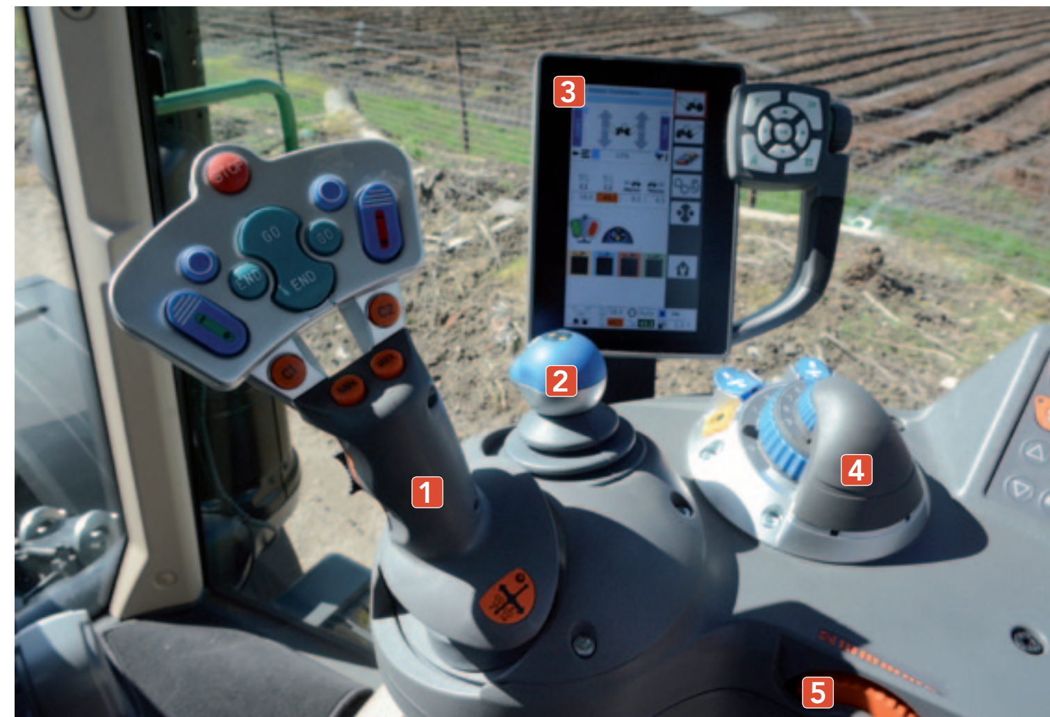
^ Nieuwe joystick Het rechterzijconsole van de Fendt 313 Vario Profi. Met de joystick [1] bedien je de transmissie. De knoppen bovenop zijn te programmeren voor hydrauliek, hef en kopakkermanagement. Er is een kruishendel [2] voor twee ventielen. Het 7 inch scherm [3] biedt instellingen en informatie. Met een hefknobbel [4] bedien je de front- en achterhef. Verder vind je in de console het handgas [5] en eenzelfde draaiknop voor de maximumrij snelheid.
