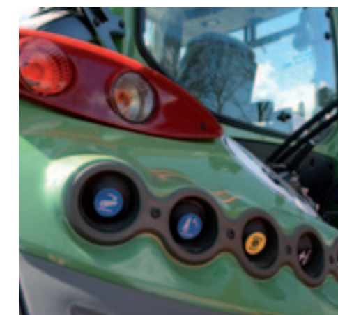
^ Bediening op spatbord Ledverlichting en bediening van een hydraulisch ventiel op het spatbord zijn opties. Bediening van hef en aftakas is standaard.
