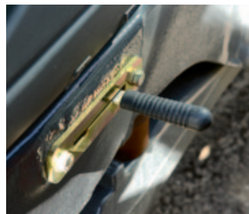
^ Frontaftakas uitschakelen Heb je de 1.000 toerenfrontaftakas niet nodig? Dan kun je de aandrijving ervan met een hendeltje boven de vooras uitschakelen.
