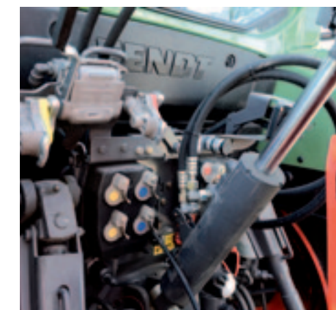
^ Vier hydraulische ventielen De loadsensing-pomp levert 110 l/min. Er zijn vier hydraulische dubbelwerkende ventielen leverbaar en een power beyond.
