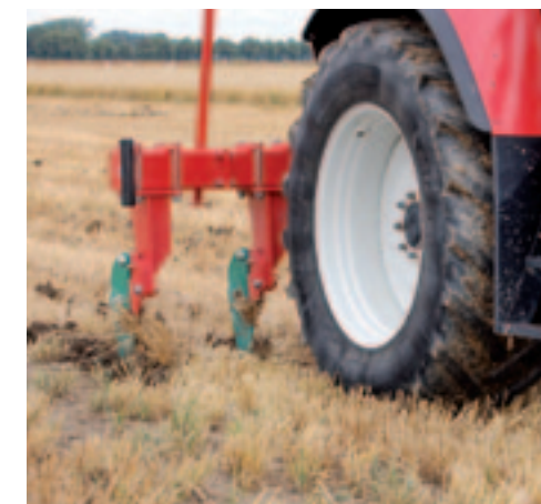
^ Woelers Op zware grond, zoals hier in 't Oldambt, heb je minder tanden nodig voor de hoofdgrondbewerking dan op lichtere gronden.
