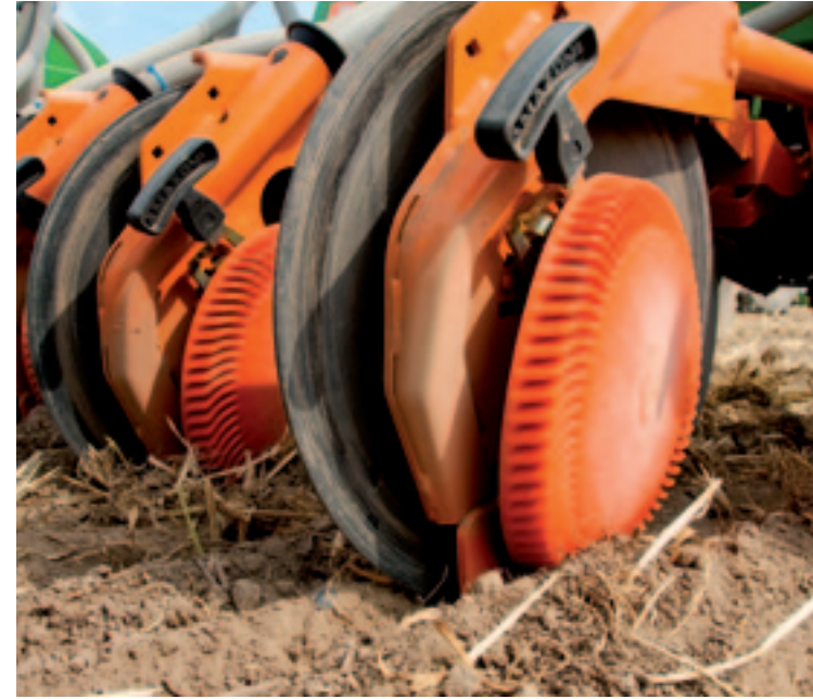
^ Schijfkouters Schijfkouters hebben in teelttechnieken waarin niet meer wordt geploegd de voorkeur. Dit koutertype heeft minder moeite met gewasresten.
