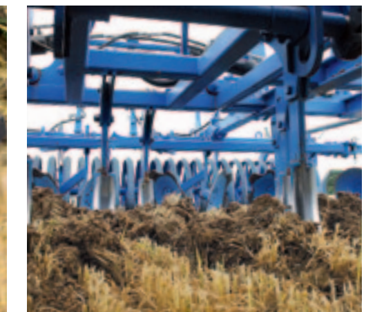
^ 80-80-80-regel Bij snelheden tot 9 km/h moet er een vrije ruimte van 80 cm vóór en naast de cultivator-tand zijn. De framehoogte is 80 cm.
