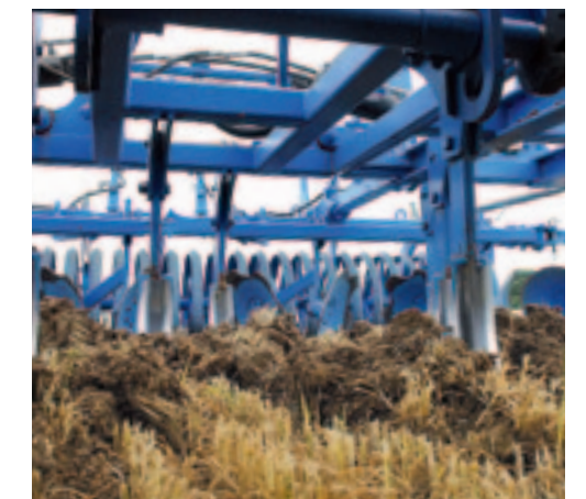
^ 80-80-80-regel Bij snelheden tot 9 km/h moet er een vrije ruimte van 80 cm vóór en naast de cultivator-tand zijn. De framehoogte is 80 cm.
