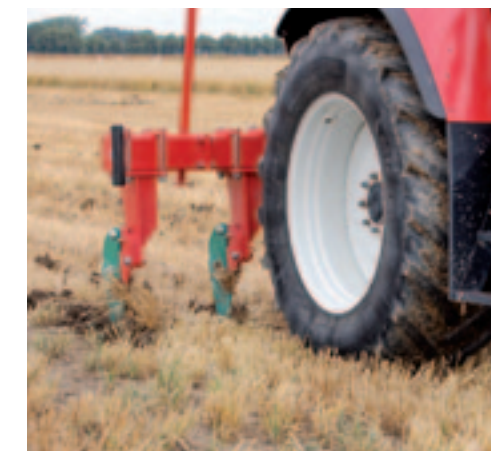
^ Woelers Op zware grond, zoals hier in 't Oldambt, heb je minder tanden nodig voor de hoofdgrondbewerking dan op lichtere gronden.
