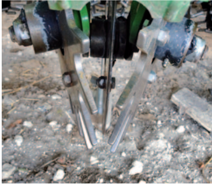
^ Roterende ruimers Sterwielen kunnen de gewasresten tot een lengte van 60 cm uit de rij werken. Zonder deze stervormige wielen is een gewaslengte van 40 cm het maximaal haalbare.
