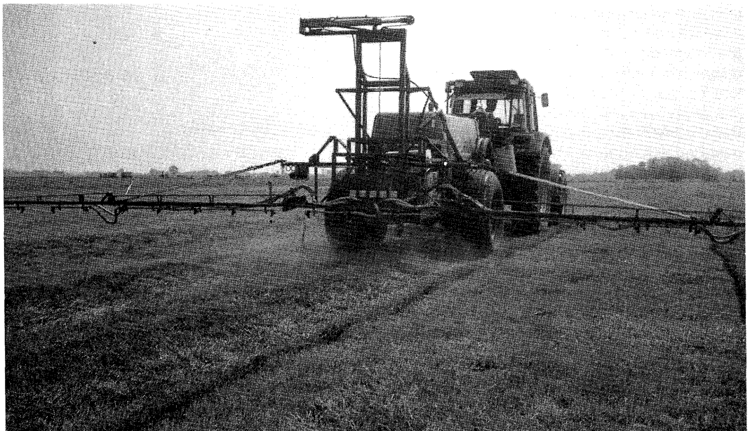
Met behulp van een sproeiboom is de afspoeling onder hoge druk gesimuleerd.
